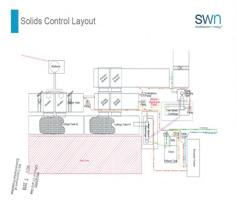
EXAMPLE SCHEMATIC FOR CLOSED LOOP SOLIDS CONTROL SYSTEM
