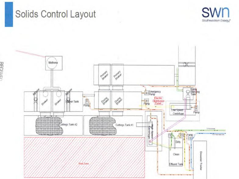
EXAMPLE SCHEMATIC FOR CLOSED LOOP SOLIDS CONTROL SYSTEM
